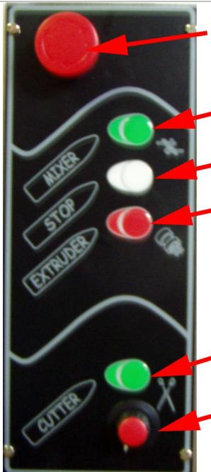
Mantenere premuto per circa 3 secondi il pulsante [3], "EXTRUSION", per avviare la macchina in modalità estrusione.
